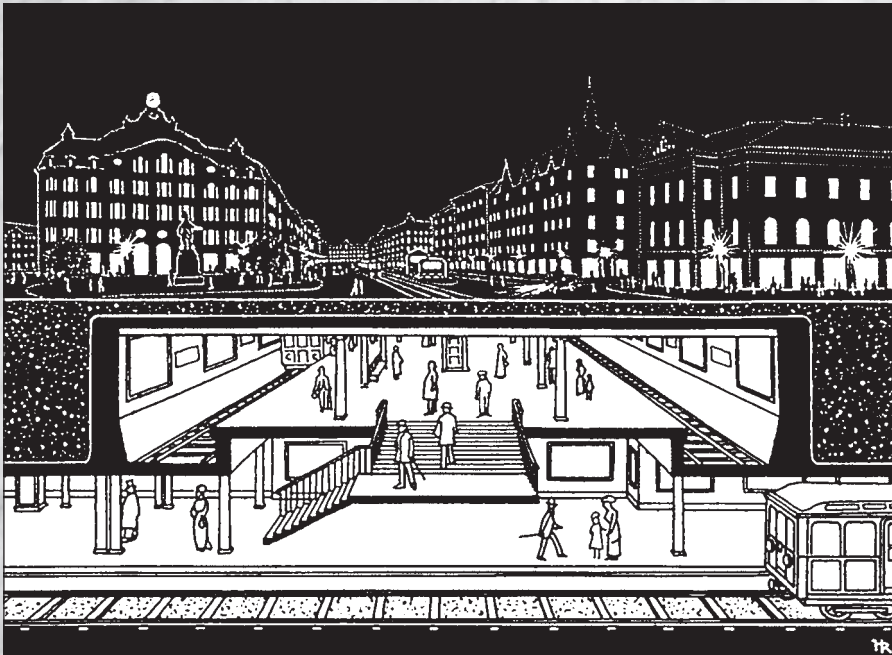
Abb. 103. Untergrundbahnhof Alexanderplatz – Schnitt mit Treppe zum Tiefbahnhof..
