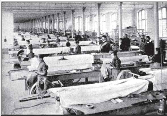
Reifenfabrikationssaal A. Vollendung der Laufdeckenfabrikation bis zur Aufbringung auf die Form.
