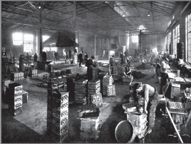
Metallgießerei für den Guss von Maschinenteilen und Armaturen. Flächeninhalt 950 m 2 • Belegschaft 30 Mann • Leistungsfähigkeit im Jahr 300 t Metallguss
